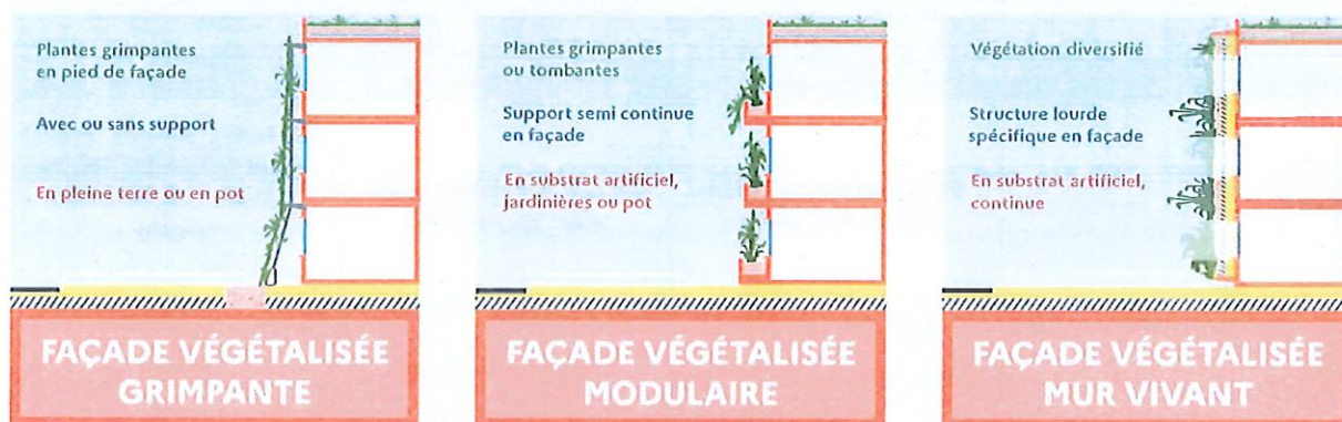
Figure 7 : Illustration des techniques de façade végétalisée
