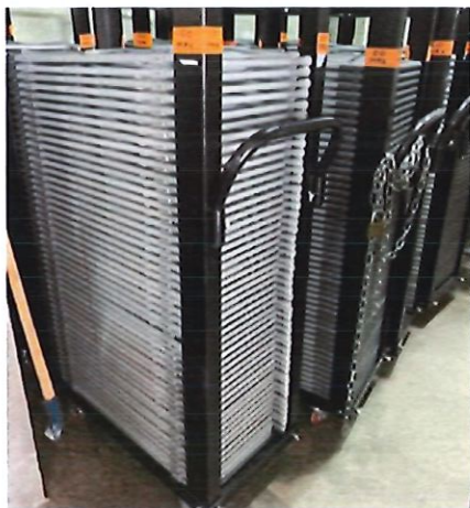
Pour se faciliter la manutention, des casiers ont été réalisés sur mesure pour transporter les chaises par lots de 50.
