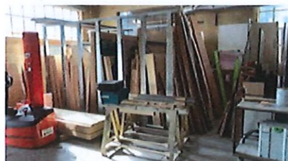
Exemple d'un stockage de bois par alvéoles verticales propre à éviter les chutes de matériaux.
