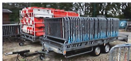
Aménagement d'une remorque avec des racks adaptés à hauteur d'épaule pour les prendre facilement. La remorque peut être déposée sur place sans mobiliser le véhicule. Un système comparable existe pour les balises.
