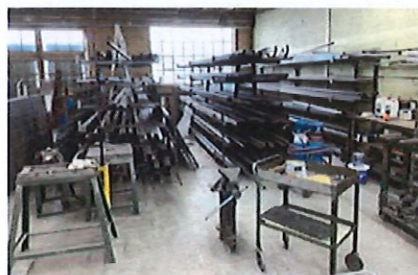
Exemple d'autre forme de stockage par rayonnage dans une métallerie : stock de tubes et tiges brutes.
