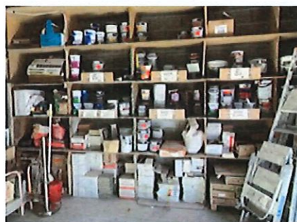
Stockage de peinture dans un atelier régie : les éléments lourds (carrelage) ont été mis en bas et les produits sont étiquetés.
